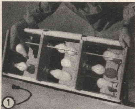
Il calore viene prodotto senza alcun pericolo delle nove lampade da 100 watt opportunamente distribuite e montate su portalampade di porcellana, da parete.
