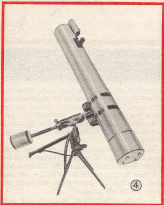
Altra veduta più completa del telescopio installato sulla montatura equatoriale, il complesso è facilmente visibile, ed individuabili sono tutte le parti che lo compongono.
