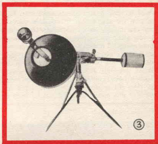
Un telescopio sistemato sulla montatura equatoriale descritta, visibile lo specchio concavo del telescopio all'interno del tubo.
